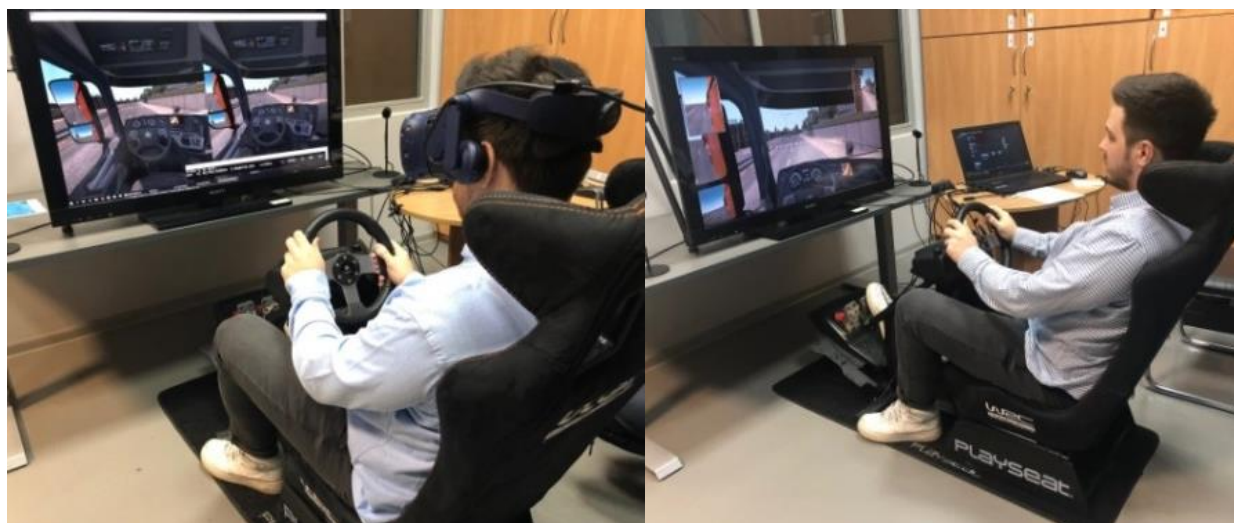
Fig. 35. Po lewej przejazd w goglach HTC Vive Pro, po prawej przejazdy przy wykorzystaniu wyświetlacza 2D.
