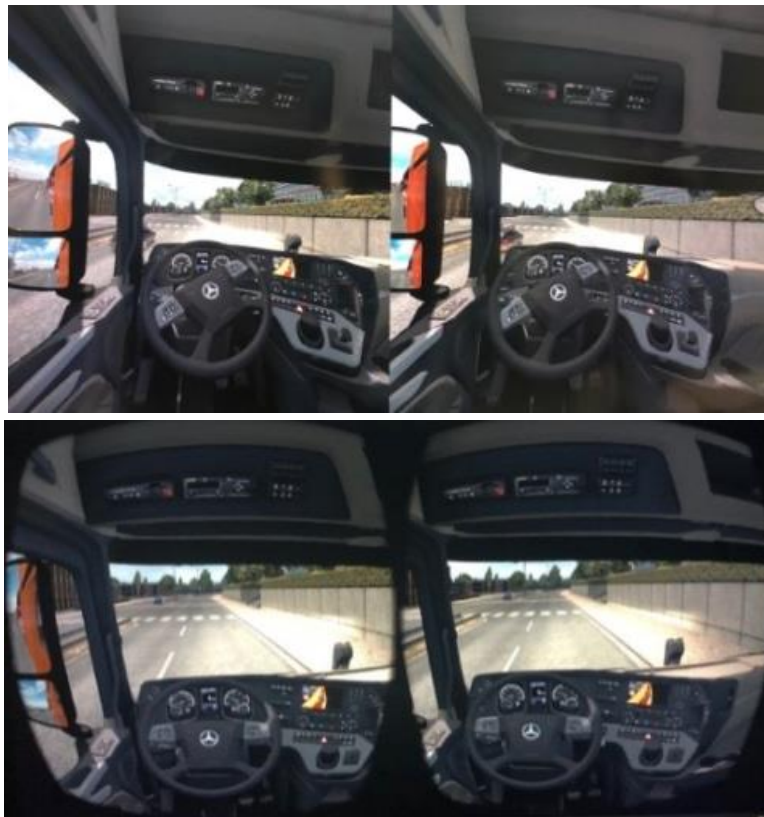
Fig. 33. Góra: Scena w wirtualnej rzeczywistości prezentowana za pomocą konwencjonalnej projekcji ekranowej. Dół: Ta sama scena w wirtualnej rzeczywistości wyświetlana za pomocą gogli HTC Vive Pro.
